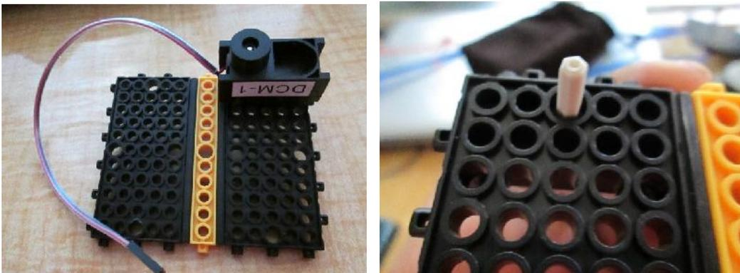
(El eje del motor debe atravesar un agujero grande del block 511)
